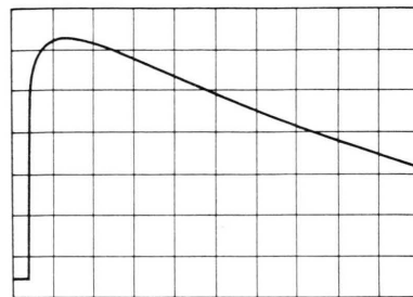
Abb. 3. Oszillogramm von Ceresorange. Defektelektronenwanderung (Vorderelektrode: \oplus ). U=31 Volt; Abszisse: 200 \mu\text{sec/Skt.} ; Ordinate: 2 \text{ mV/Skt.} Formel:
